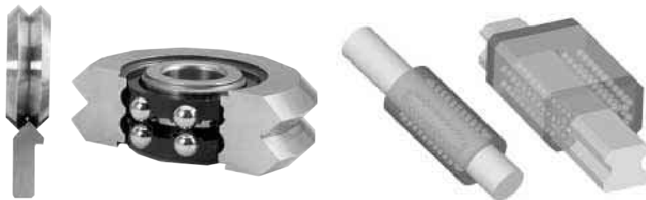
Fig. 2 La tecnologia del sistema di movimentazione DualVee (a sinistra) paragonata ad altri sistemi di movimentazione a ricircolo di sfere (a destra).
